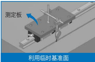
两个滑块靠紧并固定在测定板上, 以导轨安装附近设定的床台基准面为基准, 校准导轨直线度, 依序锁紧装配螺栓。
